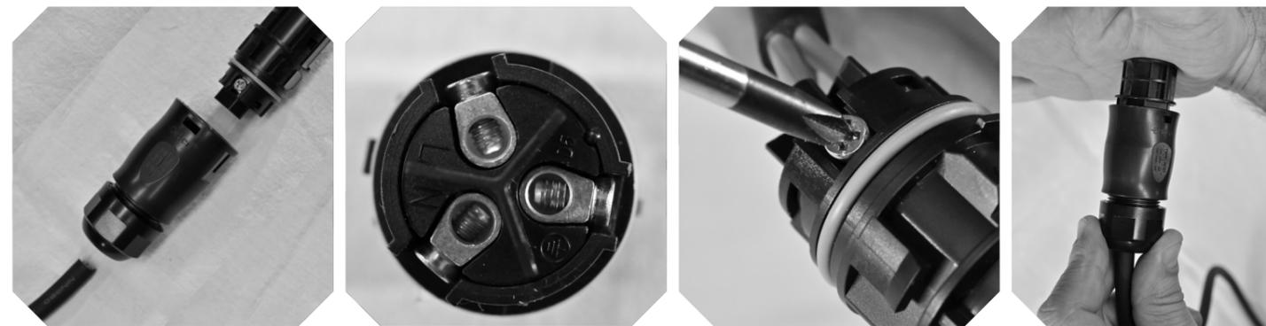
Wir drehen die Klemmschrauben etwas heraus, führen die mit Aderendhülsen versehenen Kabelenden ein und schrauben diese dann fest. Im Anschluss schieben wir die Hülle wieder darauf. Es bedarf etwas Kraft und es muss „klick“ machen, dann sind Stecker und Gehäuse fest miteinander verbunden. Es soll kein Wasser in das Gehäuse eindringen können. Hier zu sehen ist ein BC01 Stecker, der Ablauf ist aber bei jedem Steckertyp - auch Schuko vergleichbar. Videos dazu auf der Website.
